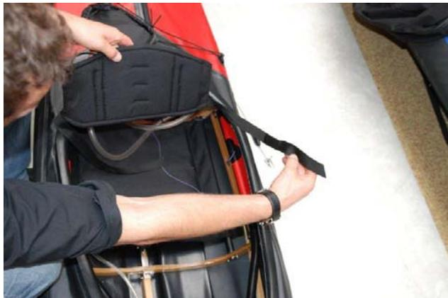
Installieren Sie dann die Rückenlehne. Das gerade Ende der Lehne gehört nach unten, das gebogene zeigt nach oben.
