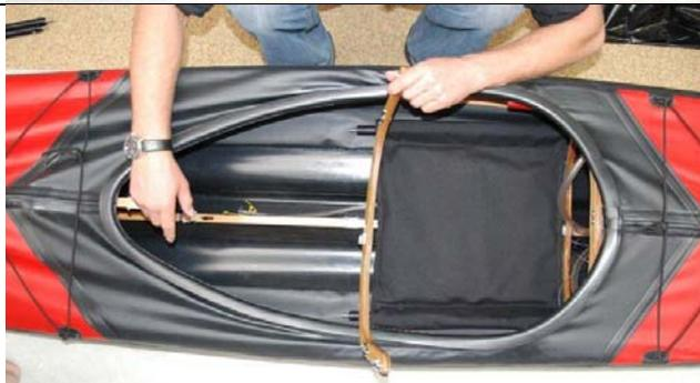
Nehmen Sie dann den Halbspant (# 4) zur Hand und installieren Sie diesen zunächst an den Seitenbordwänden.
