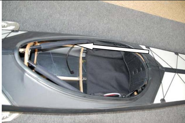
Führen Sie dann den Bowdenzug von hinten nach vorne ins Cockpit. Führen Sie ihn ganz aussen und seitlich oberhalb der Spanten nach vorne. An der Position stört er auch bei Beladung in keiner Weise.
