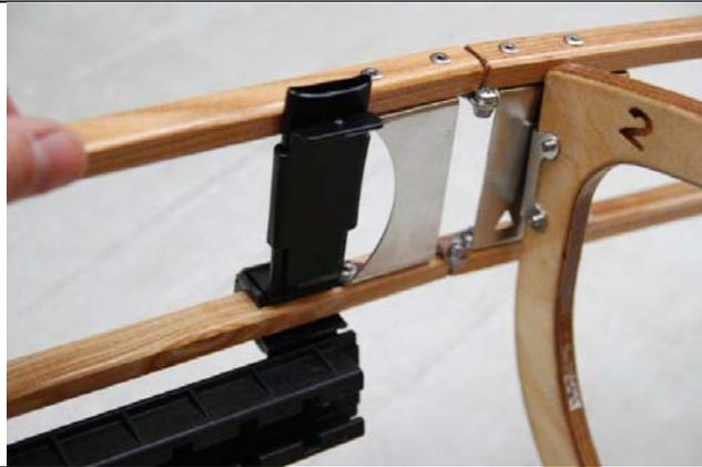
Die Schiene sitzt direkt am Beschlag der Seitenbordwand an.
