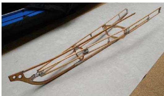
Setzen Sie in gleicher Weise den Spant # 6 ein. Es ergibt sich nebenstehende Abbildung. Der Aufbau des Heckelements ist abgeschlossen.
