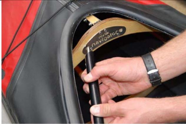
Das vorder Ende der Schenkelstütze wird in den Spant # 3 geschoben.
