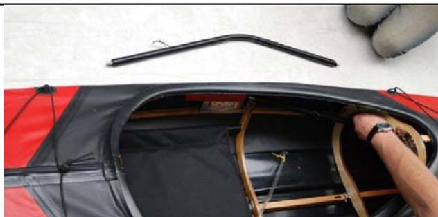
Nehmen Sie dann die Schenkelstützen und fädeln diese durch die Seitenteile (mit aufblasbaren Elementen) des Sitzes und durch die zweigeteilte Lasche an der Cockpitseite innen ein. Hinweis: Bild zeigt den Sitz noch ohne die Hip-Fit-Pads.
