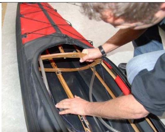
Achten Sie darauf, dass die seitlichen Flügelbeschläge richtig in die Bordwände greifen. Dazu müssen Sie die Bordwand eventuell etwas zum Spant in die richtige Position drücken.
