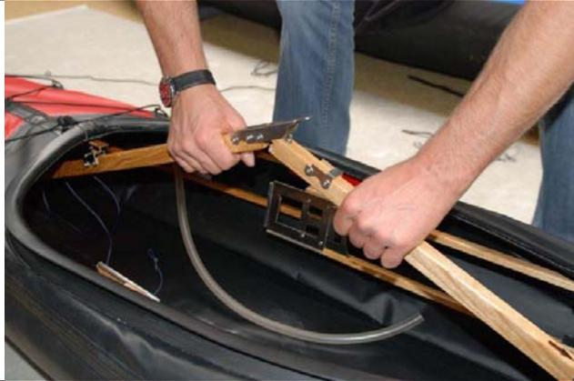
Nehmen Sie die beiden Killeisten nach oben und setzen Sie die mit Schraubkopf unter die mit dem überstehenden Beschlag.
