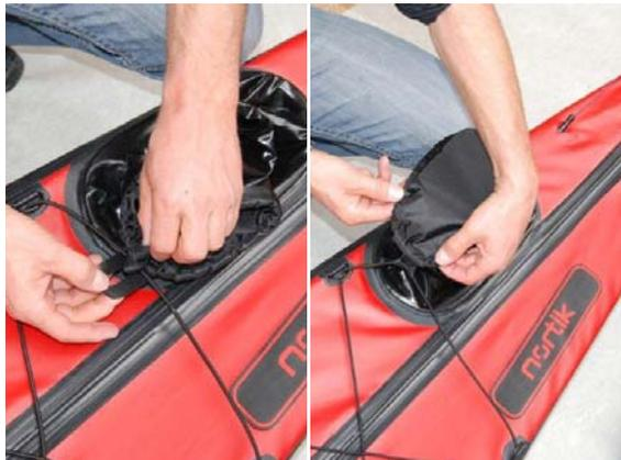
Führen Sie die Schlaufe einmal unter der Deckbeleinung durch und fädeln dann die gesamte Abdeckung durch die Schlaufe und ziehen es fest.
