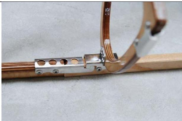
Schieben Sie danach die untere „Nase“ in den Beschlagn auf den Kiel. (Anmerkung: Sollte dies nicht möglich sein, können Sie die Nase mit einer Zange vorsichtig noch etwas nach unten biegen. Achten Sie dabei darauf, dass Sie die „Nase“ nur minimal biegen)
