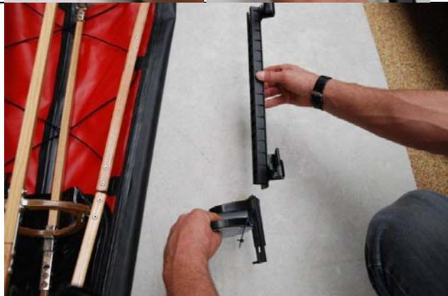
Nehmen Sie dann bitte die Schiene zur Hand und setzen diese am Buggerüst ein. Die Schiene kommt an die Seitenbordwand vor den zweiten Spant (vom Cockpit aus gesehen). Dazu setzen Sie die Schiene von aussen schräg an und schieben sie zwischen die Leisten. Die Halterungen wiederum werden dann von aussen an die Seitenbordwand gedrückt. Schließen Sie dann den Verschluss. Die Schiene setzt direkt am Beschlag der Seitenbordwand an. Im Folgenden sehen Sie die Vorgehensweise:
