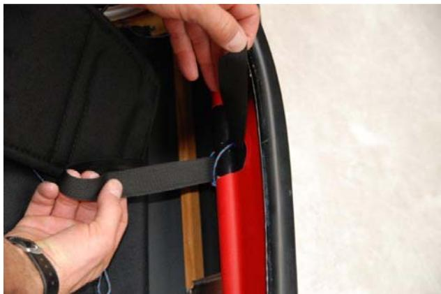
Fädeln Sie den Spanngurt durch die Halterung an der Schenkelstütze. Fädeln Sie dann den Gurt in das Gegenstück auf der Rückseite der Lehne ein.
