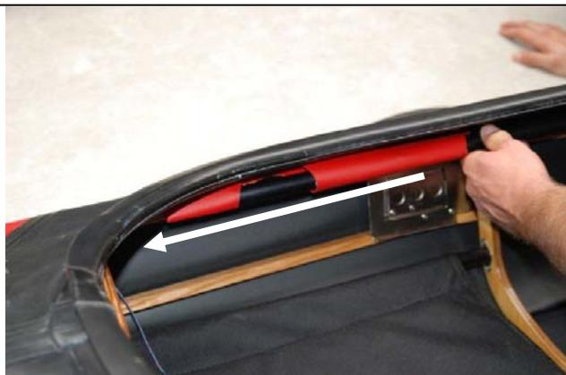
Schieben Sie die Schenkelstütze in das Aufnehmerloch im Spant # 5.
