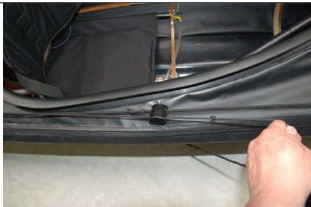
Führen Sie das Seil dann durch den verschiebbaren Clip, ca. auf Höhe zwischen dem Spant #3 und #4, ziehen es straff und machen einen Knoten in das Seil.
