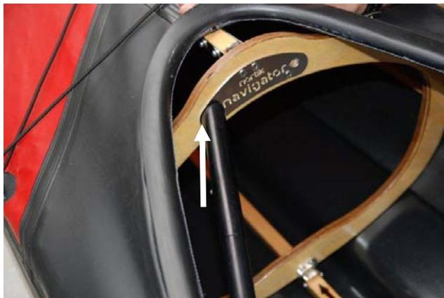
Schieben Sie dazu die Schiebehülse nach vorne bis die Federnase der Hülse in das dritte Loch eingerastet ist.
