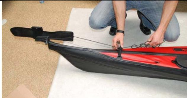
Führen Sie dann die Aufholleine, welche am Ruder befestigt ist, durch den hintersten D-Ring. Führen Sie die Leine weiter (evtl. an der Ladeluke vorbei, je nachdem auf welcher Seite Sie die Aufholleine installieren) durch die drei D-Ringe.
