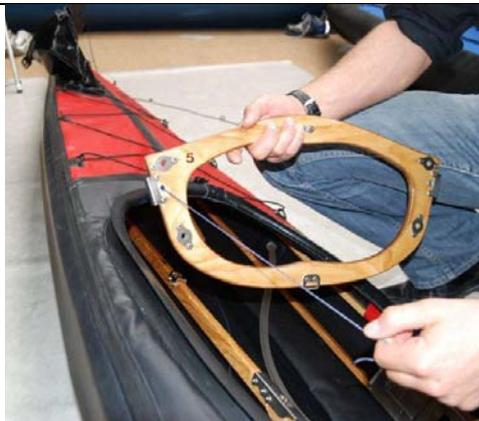
Nehmen Sie nun Spant # 5 zur Hand und installieren diesen. Wichtig: Setzen Sie die Spanten # 5 und auch # 3 so herum ein, dass der Firststab in den Beschlag auf der Oberseite des Spants greifen kann. Der Beschlag zeigt also vom Cockpit weg.
