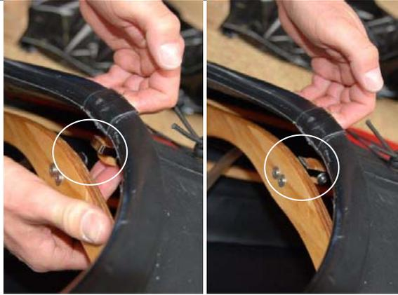
Hängen Sie den Firststab oben am Spant ein.
