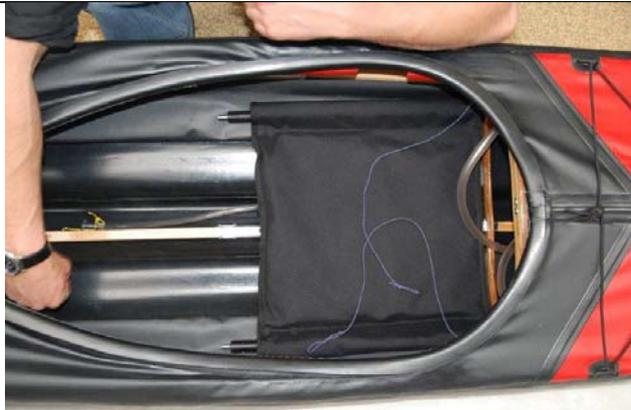
Stecken Sie dann die Sitzstangen zunächst am hinteren Cockpit-spant # 5 auf.
