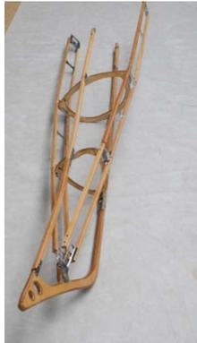
Der Aufbau des Bugs erfolgt analog dem Heck. Klappen Sie die Seitenbordwand auf und fädeln diese in den Bugstegen ein. Setzen sie den Firststab und die Kielleiste ein. Installieren Sie Spant #1 und Spant #2 (Flügel zeigen in Richtung Cockpit). Es ergibt sich das Bugelement wie in linksstehender Abbildung zu sehen.
