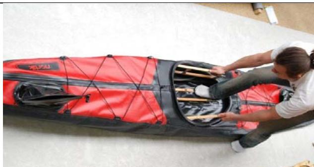
Schieben Sie die das Gerüst gerade in die Bootshaut. Orientieren Sie sich dabei am Kiel und am Verstärkungsstreifen des Firststabs am Oberdeck. Greifen Sie die Seitenbordwände und schieben Sie das Gerüst flach soweit wie möglich in die Bootshaut.
