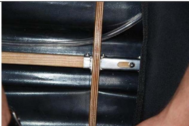
Achten Sie bitte darauf, dass die Laschen, in welche die Schenkelstützen später eingefädelt werden, frei liegen und nicht hinter der Bordwand eingeklemmt sind.
