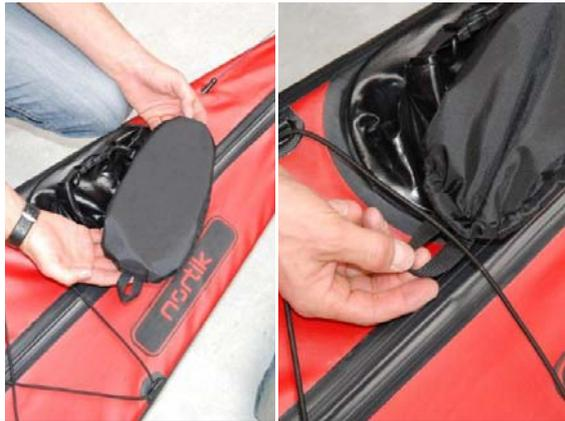
Nehmen Sie dann die beiden Ladeluken-Abdeckungen zur Hand und befestigen diese auf der Deckbeleinung. Das wird einmal gemacht und in Zukunft belassen Sie die Abdeckungen einfach daran.
