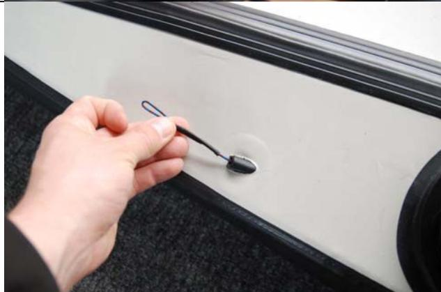
Nehmen Sie dann den Bowdenzug zur Hand und führen das andere Ende vom Bootsinneren (durch die hintere Ladeluke) durch die Steuerauslassröhrchen hindurch. Gehen Sie wie folgt vor: Erst führen Sie das Steuerseil selbst durch.
