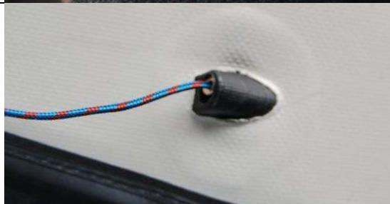
Dann drücken Sie den Bowdenzug durch den Auslass. Am einfachsten machen Sie etwas kreisende Bewegungen und drücken gleichzeitig kräftig. Solange bis der Bowdenzug hindurch kommt.
