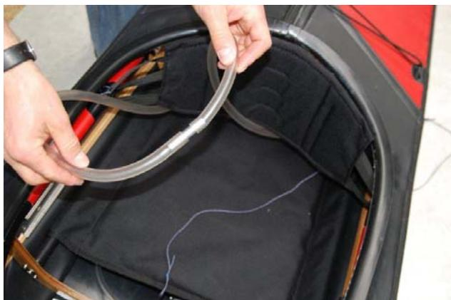
Die beiden anderen Spanngurte führen Sie bitte einmal um den Spant #5 herum und klicken den Schnellverschluss wieder ein.
