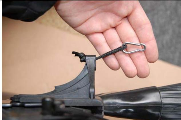
Befestigen Sie dann am durchgeschobenen Ende des kurzen Seils wieder den kleinen Karabiner. Gehen Sie identisch auf der anderen Seite und mit dem anderen Bowdenzug vor. Das Seil und der Karabiner bleiben nun immer am Steuer dran. In den Karabiner wird das Steuerseil, welches Sie im nächsten Schritt nach hinten ausleiten, eingehängt.
