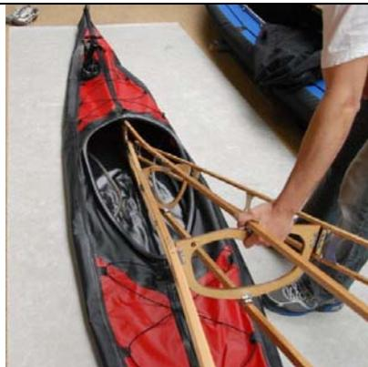
Führen Sie zunächst das Heckelement in das Boot ein.
